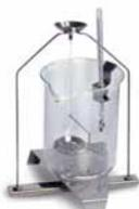
**Set zur Dichtebestimmung** von Flüssigkeiten und Feststoffen mit Dichte  $\geq 1$ , KERN ALS-A01
